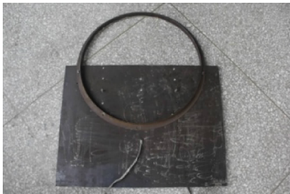
图 9 可调式插板扰流器 Fig. 9 Picture of adjustable flat-baffle-type distortion generator
